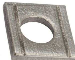
Cale biaise pour UPN, pente a 8% DIN 434
