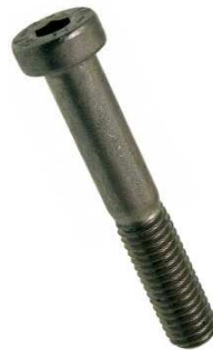
VIS CHC 8.8 BRUT/ZINGUÉ DIN 7984 Tête basse
