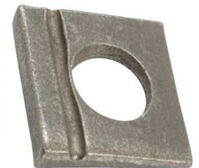
Cale biaise pour IPN, pente a 14% DIN 435
