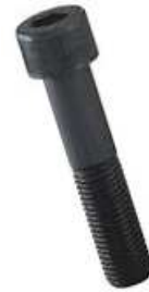
VIS CHC 12.9 UNF ANSI B18-3 Cote en Pouce
